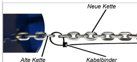
Kabelbinder oder Draht am Ende der alten Kette befestigen und die neue Kette damit langsam durch die Kettenführung ziehen.
