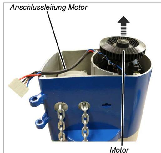
➔ Motor aus dem Gehäuse ziehen.
