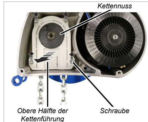
➔ Schrauben (4x) aus der Kettenführung schrauben.
