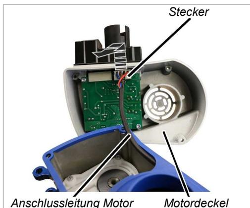
➔ Stecker der Anschlussleitung des Motors von der Platine abziehen.
