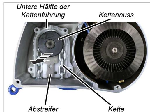
➔ Untere Hälfte der Kettenführung mit Kettennuss, Kette und Abstreifer aus dem Gehäuse nehmen.
