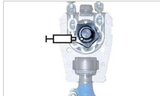
Schmierung durch Klüber „Staburags NBU 12 Alltemp“ AN 14980.
