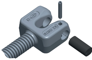
Abb. 2: Montage Bolzen und Spannhülse
